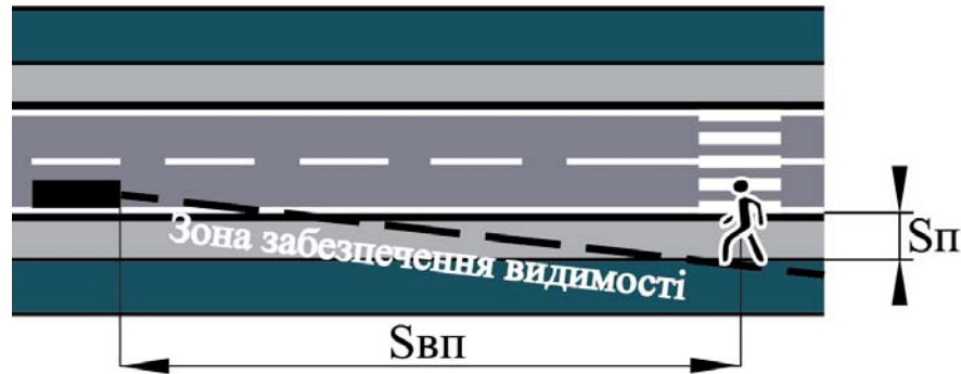
Рисунок 4.3 – Схема визначення зони видимості на нерегульованому наземному пішохідному переході
